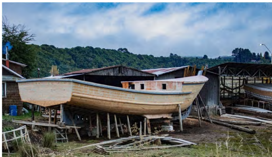
Imagen 48: Lancha en construcción. El espejo (popa) a la izquierda. San Juan, comuna de Dalcahue. Foto David Núñez.
