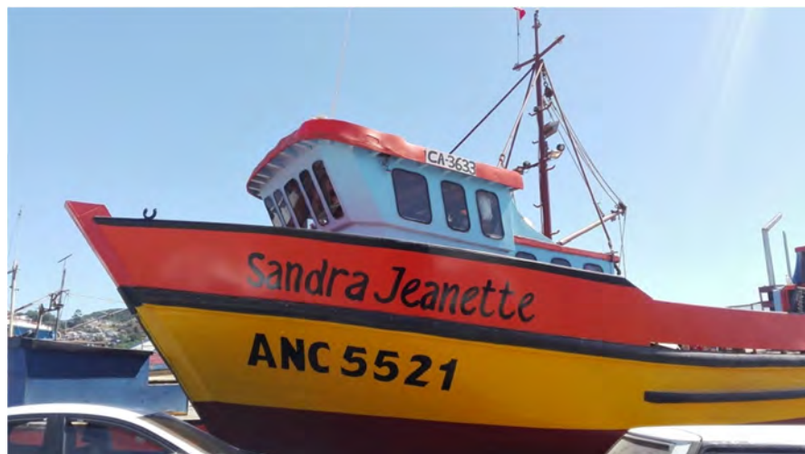
Imagen 17: Embarcación pesquera, de madera, enfibrada, Calbuco. Foto: M. González.
