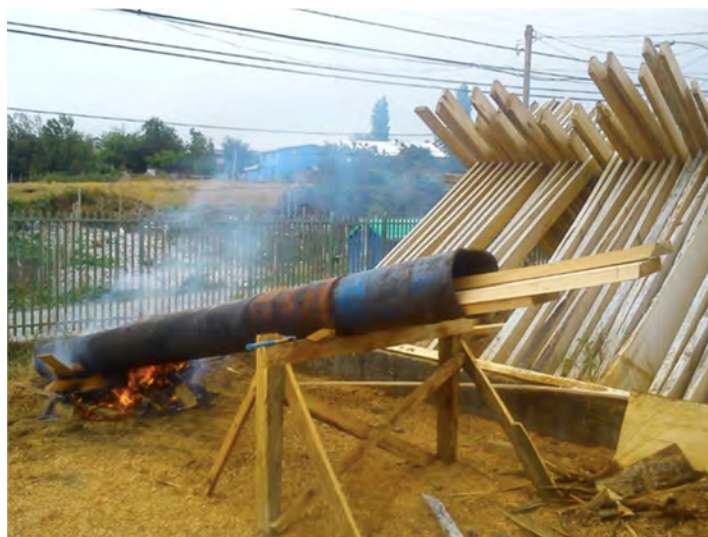
Imagen 25: Tubo de acero para cocer madera. Fuente: Astillero de Hugo Almonacid.
