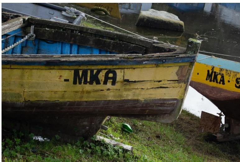
Detalle de la bambota en una chalupa a motor (sin hélice ni timón la de la foto). Melinka.
