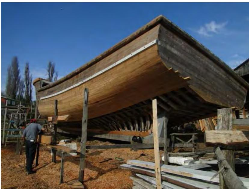
***Lancha motora en construcción***
