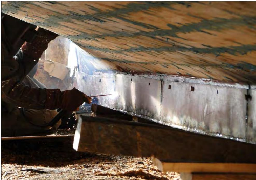
***Revestimiento metálico de quilla en lancha motora***
